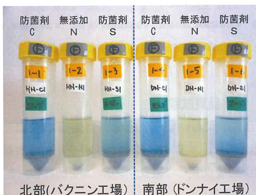
写真-2 防菌性能判定薬試験結果
